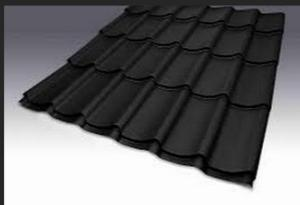
Teja continua curva, es una cubierta habitacional de acero de largo continuo, con claras ventajas estructurales y de estanqueidad. Su sistema de traslape laterales corta la filtración de agua por capilaridad.
